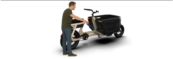
Imagen 14: Extracción de la batería
