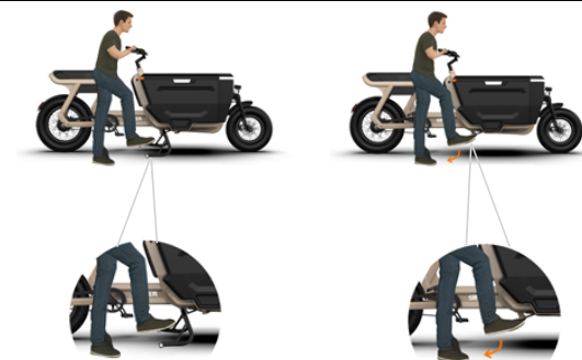
Image 8 : Utilisation du support central
