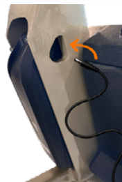
Bild 13: Laddning av batteriet i cykeln
