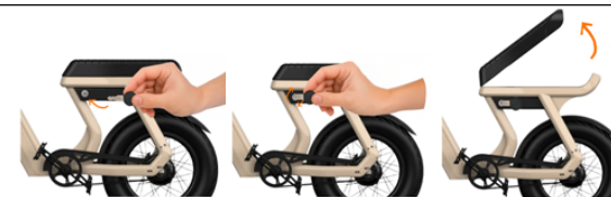
Abbildung 11: Öffnen des Beifahrersitzes
